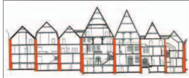
Abb.11: Schnitt durch die Häuserzeile Große Petersgrube mit Hervorhebung der gemeinsamen Brandmauern
